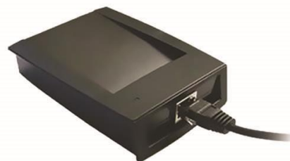
کارت خوان رومیزی مایگرم مدل RW500 فرکانس کاری: 13.56KHZ
