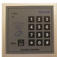
سیستم کنترل دسترسی مدل 236 فرکانس کاری: 125KHZ
